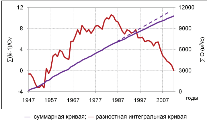
Рисунок А.3.2 – Суммарная и разностная интегральные кривые слоев весеннего половодья по г/ст. р.Кема - д.Левково
