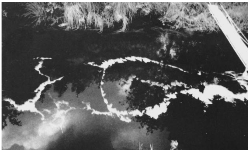
Рис. 12.2. Распространение имитатора нефти (растительное масло) и алюминиевой пудры на открытой водной поверхности р. Юля-Йоки (течение справа налево). Белое обрамление неправильной формы — это алюминиевая пудра, перемещенная тонкослойным разливом масла на его внешнюю границу
