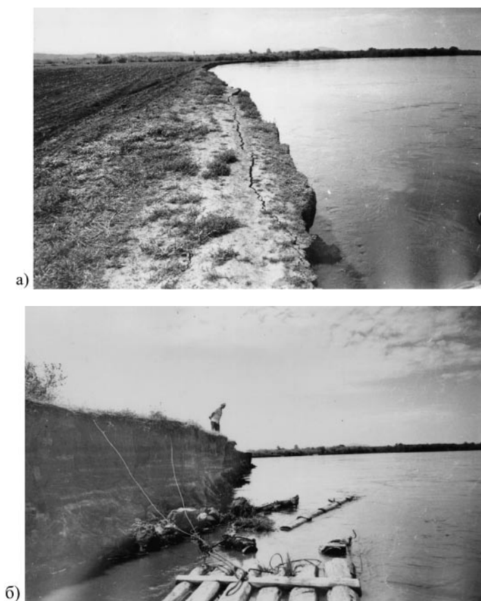
Рис. 8.7. Размыв пойменного берега: а — начальная стадия размыва пойменного берега (вид по течению); б — вторая стадия размыва пойменного берега (вид по течению)
