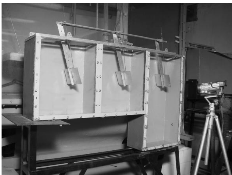
Рис. 2.9. Трехсекционный волновой резервуар
