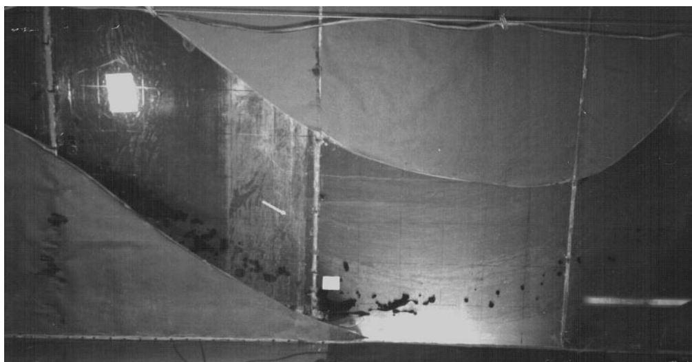
Рис. 12.7. Характер движения нефтяных частиц на изгибе лабораторного лотка в условиях «ледостава» (силикатное стекло). Вид сверху, течение слева направо
