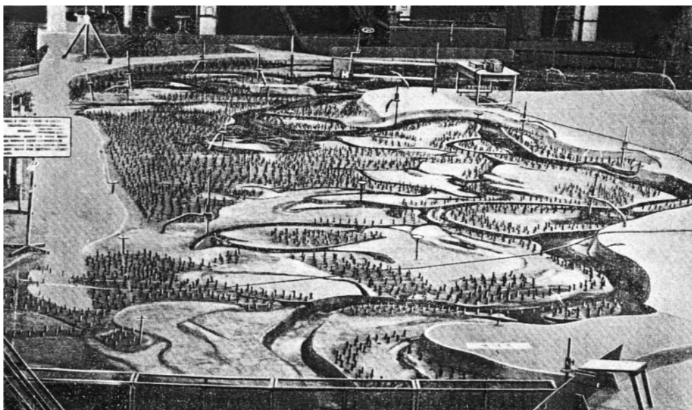
Ри. 8.28. Общий вид гидравлической модели р. Иртыш
