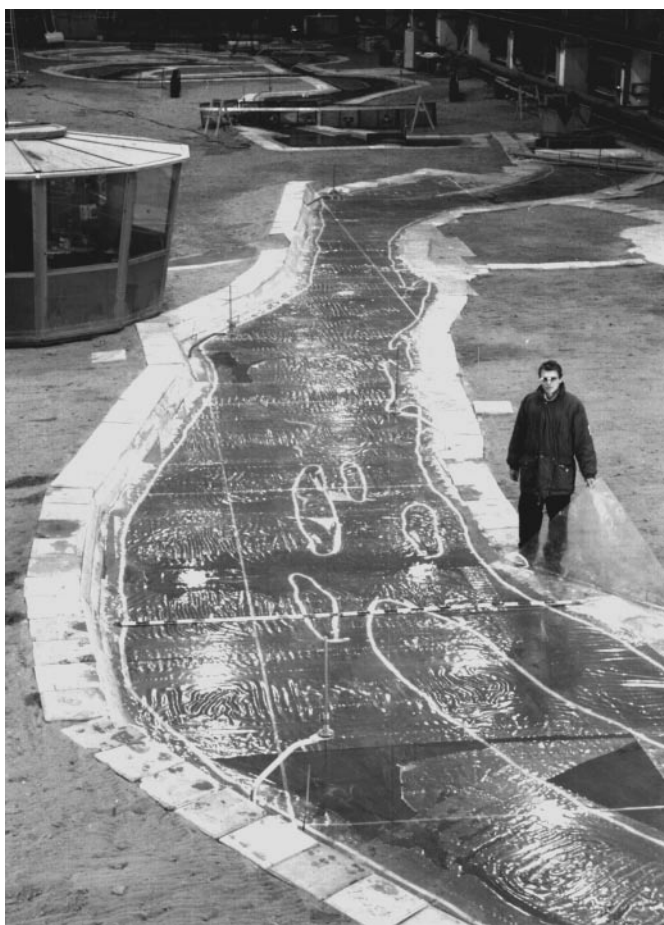
Рис. 12.11. Модель р. Волги, покрытая ПХП пленкой для изучения трактов распространения аварийных разливов «нефти» под «ледяным» покровом
