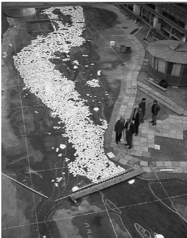
Рис. 11.19. Общий вид гидравлической модели участка русла р. Лены у с. Табага
