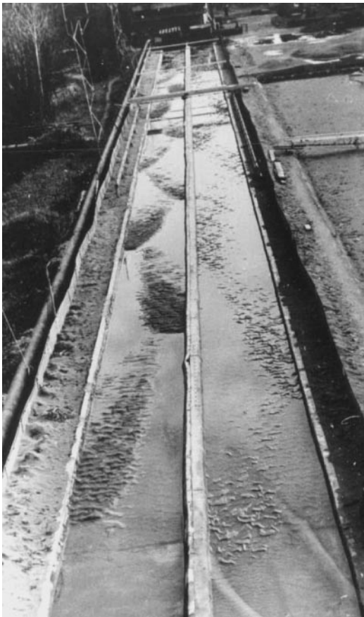
Рис. 4.6. Побочни в 82-метровом гидравлическом лотке
