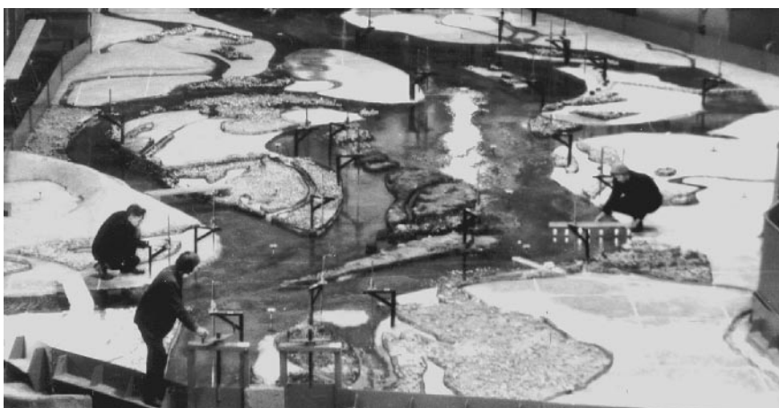
Рис. 8.8. Общий вид гидравлической модели р. Селенги (вид против течения)
