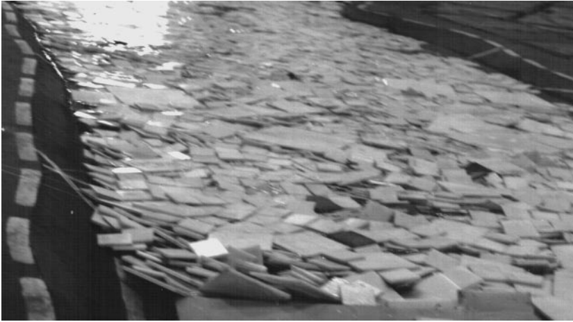
Рис. 11.8. Образование затора торошения у кромки ледяного покрова (фото после спуска воды с модели)
