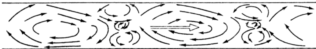
Рис. 3.4. Схема кинематической структуры потока по М.А. Великанову
