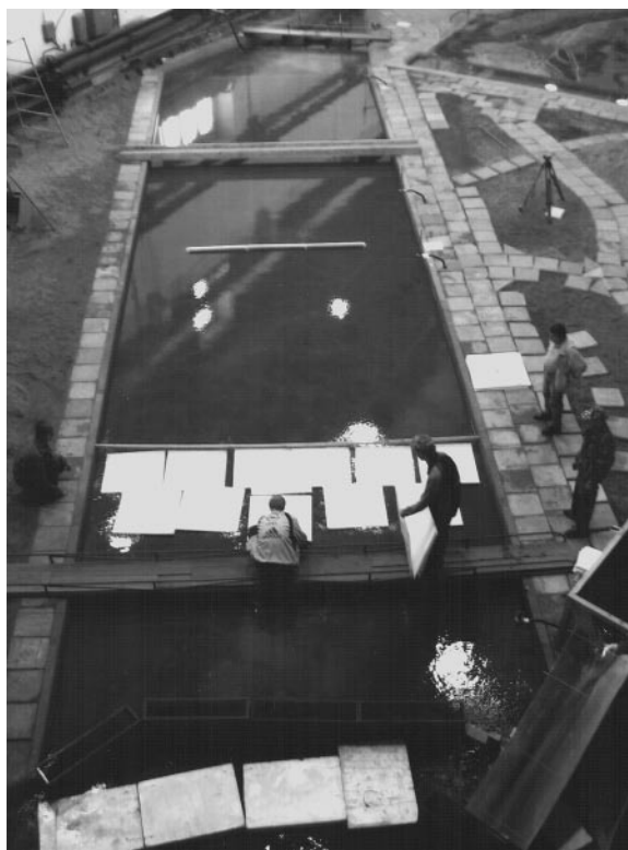
Рис. 11.22. Общий вид экспериментального стенда – 20-метрового канала прямоугольного поперечного сечения
