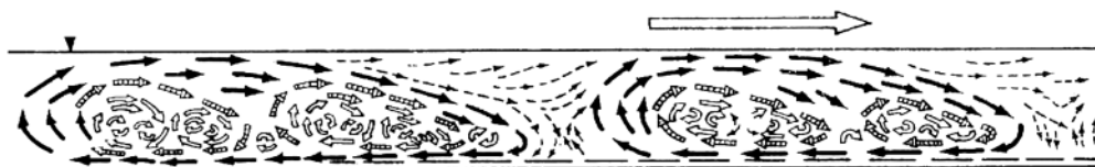
Рис. 3.17. Схема кинематической структуры руслового потока, построенная по материалам лабораторных экспериментов ГГИ
