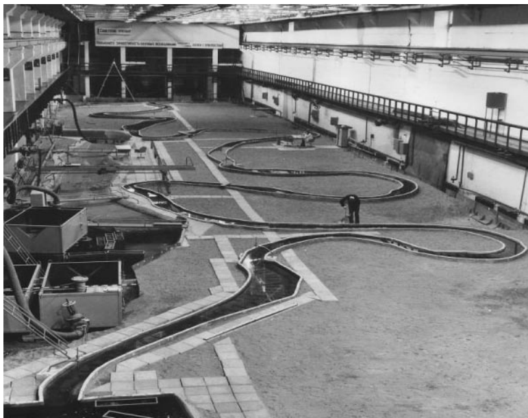
Рис. 6.1. Общий вид схематической модели меандрирующего русла р. Иртыш
