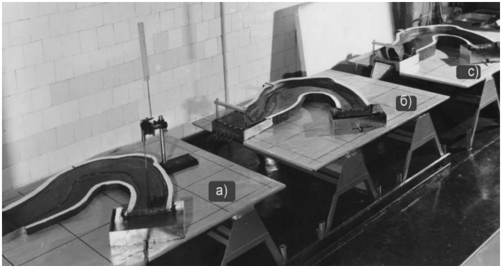
Рис. 4.19. Модели излучины р. Полонети в масштабах: а – M_r 1:200 , M_b 1:200 ; б – M_r 1:200 , M_b 1:100 ; с – M_r 1:200 , M_b 1:50
