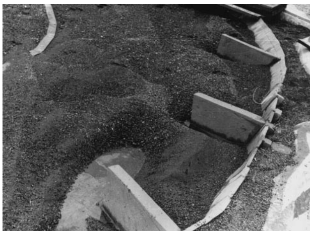
Рис. 10.16. Характер местных размывов оголовков незатопляемых шпор после опыта при расходе воды 0,33 %-ной обеспеченности
