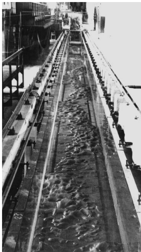
Рис. 4.8. Побочневый тип руслового процесса (опыты М.М. Гендельмана) в 100-метровом гидравлическом лотке
