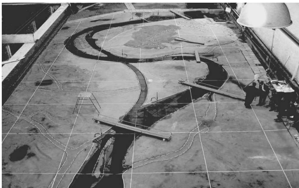
Рис. 8.27. Общий вид модели с руслом в проектных условиях (спрямляющий канал). Вид по течению
