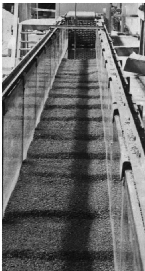
Рис. 10.6. Плоские гряды в экспериментах пятой серии
