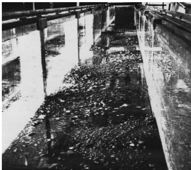
Рис. 10.5 Опыт с керамзитом. Перекошенные гряды (побочки)
