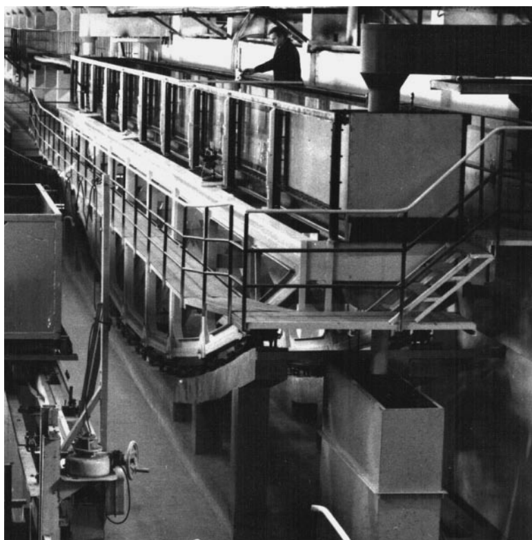
Рис. 2.5. 25-метровый лоток с переменным наклоном
