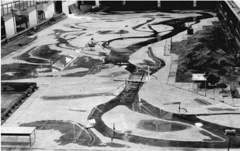
Рис. 8.21. Общий вид гидравлической модели р. Оби у г. Барнаула (вид против течения)
