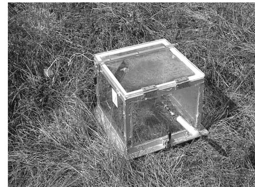
Рис. 5.1.1. Светопроницаемая камера, установленная в центральной части болотного массива. К штуцеру присоединен шприц для отбора пробы воздуха
