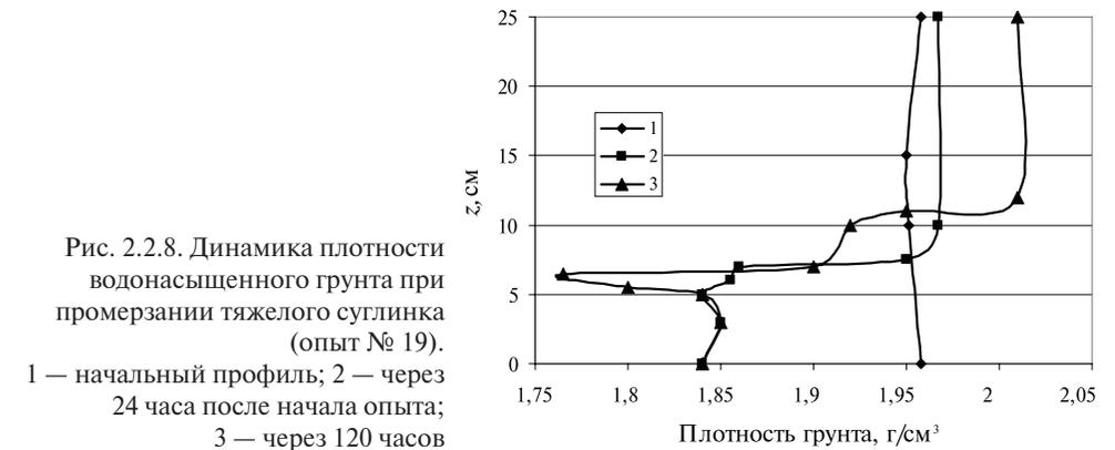
Рис. 2.2.8. Динамика плотности водонасыщенного грунта при промерзании тяжелого суглинка (опыт № 19).
