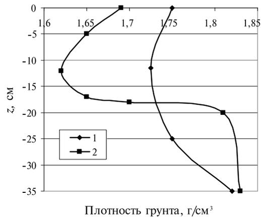
Рис. 2.2.5. Динамика плотности водонасыщенного грунта при промерзании среднего суглинка (опыт № 10).
