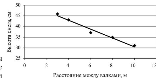
Рис. 3.5.1. Зависимость средней высоты снега в межвалковом пространстве от расстояния между валками
