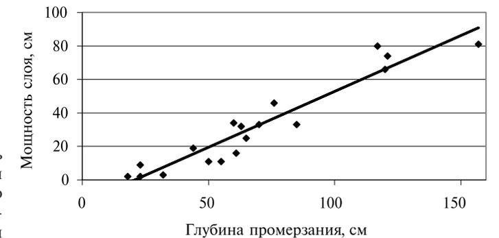
В настоящее время для определения глубины промерзания почвы используют результаты наблюдений за температурой почвы по показаниям вытяжных почвенно-глубинных термометров и мерзлотомеров. Поэтому возникает необходимость сравнения данных о глубине промерзания почвы, измеренных разными методами.
