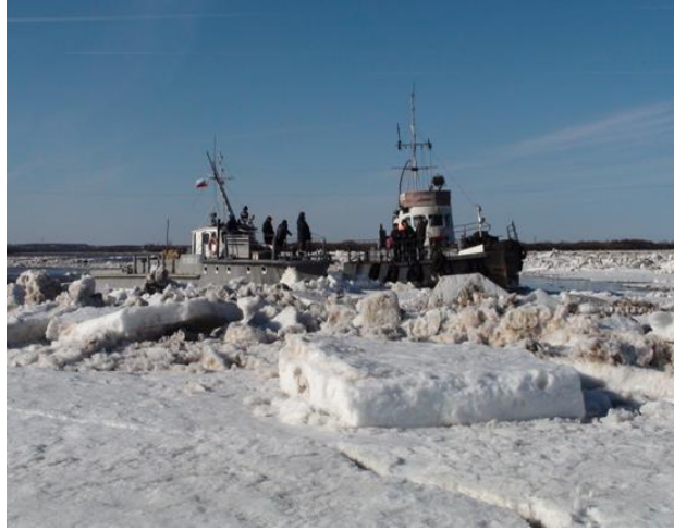
Рис. 10.2. Ликвидация заторного скопления льда ледоколами на реке Юг в апреле 2008 г.
