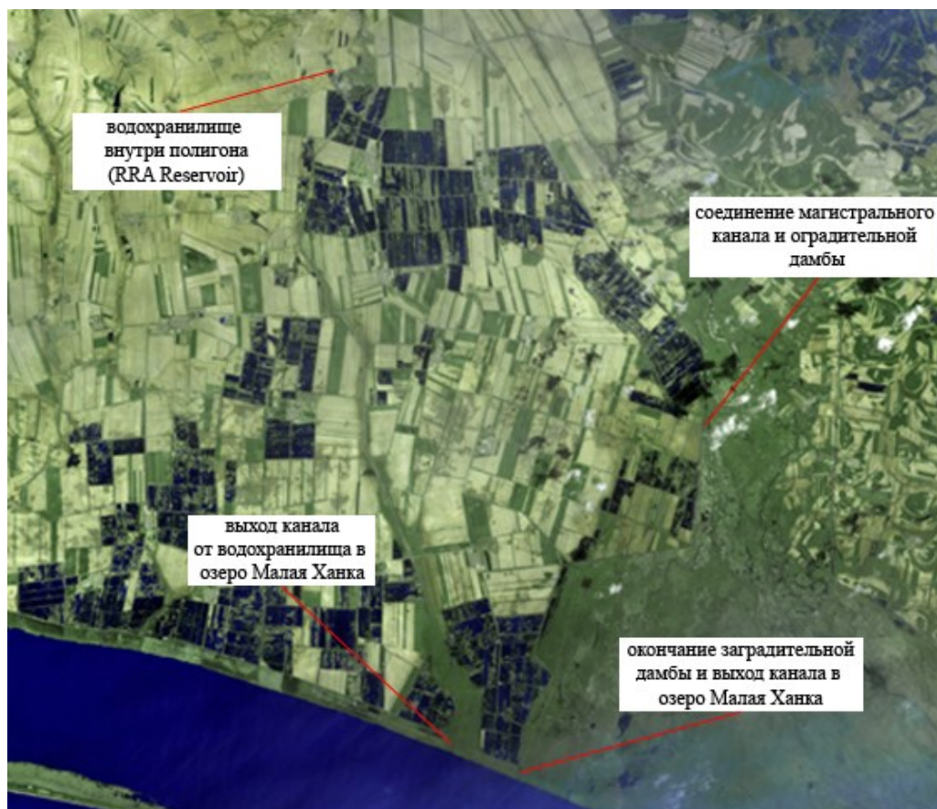
Рисунок 5.14 – Водораспределительная система на снимке за 04.05.1998 г.
