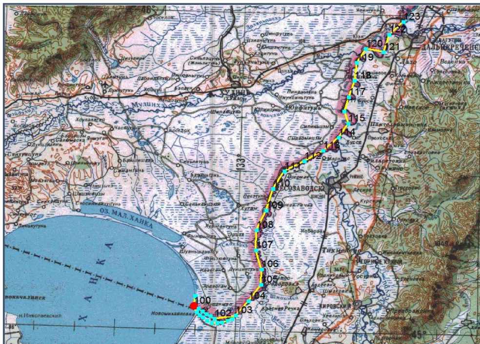
Рисунок 11.1 – Карта-схема расположения основных узлов расчетной сетки гидродинамической модели
