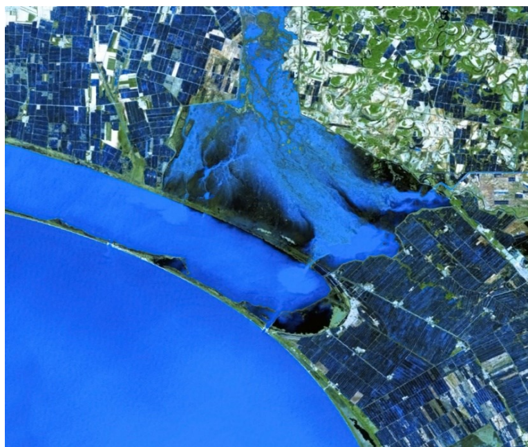
Рисунок 5.20 – Просачивание воды через дамбу в оз. Малая Ханка и вынос через западное ГТС в оз. Ханка
