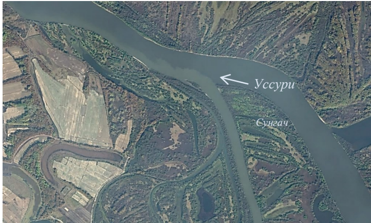
Рисунок 10.7 – «Шлейф мутности», сформированный водным потоком Сунгача в районе его впадения в Уссури
