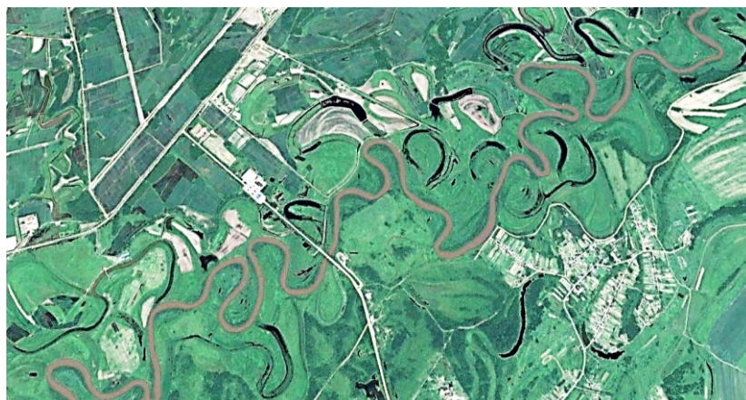
Рисунок 10.10 – Участок в нижнем течении реки со следами спрямлений и более плавными формами излучин
