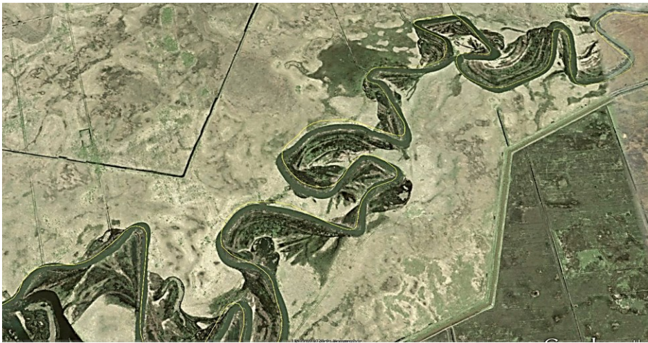
Рисунок 10.8 – Участок 21–34 км от истока со следами сползания излучин вниз по течению (деформации по типу ограниченного меандрирования)
