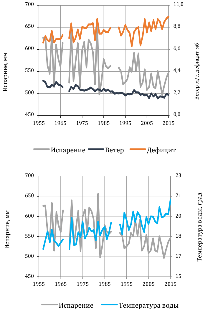
Рисунок 6.17 – Многолетние изменения испарения, скорости ветра, дефицита влажности и температуры воды по данным наблюдений на водноиспарительной площадке Астраханка за теплый период 1957–2015 гг.
