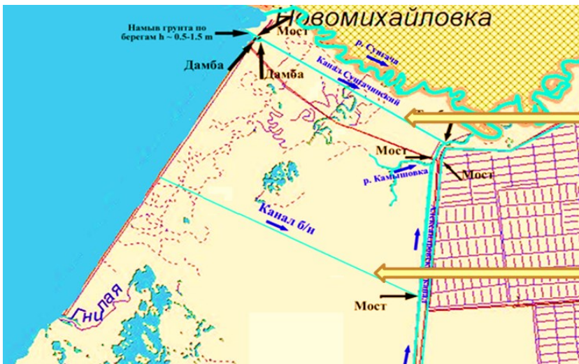
Рисунок 5.33 – Схема расположения водоотводящих каналов из оз. Ханка
