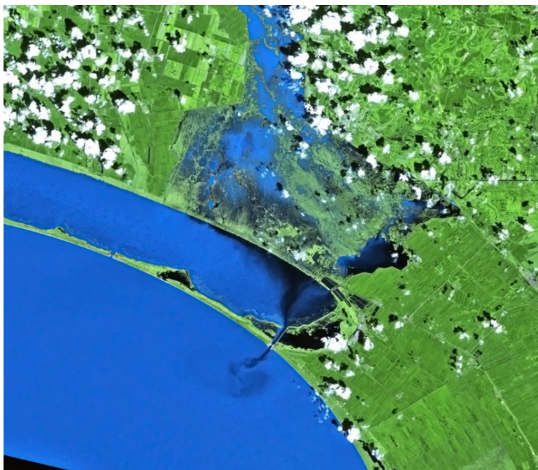
Рисунок 5.19 – Просачивание воды через дамбу в оз. Малая Ханка и вынос через восточное ГТС в оз. Ханка
