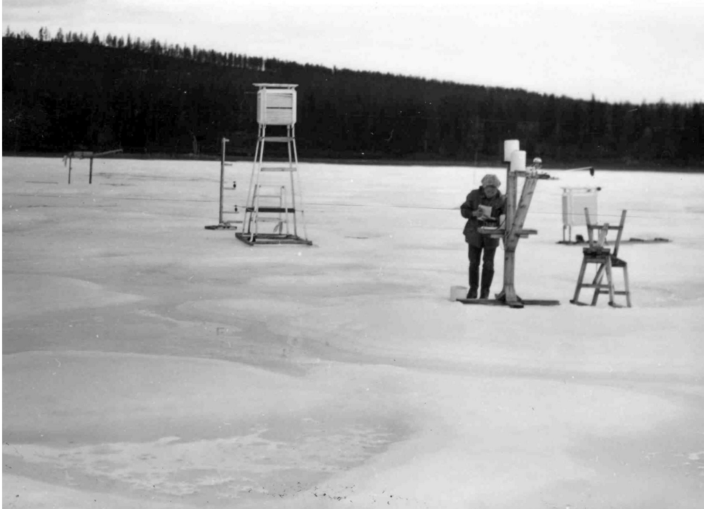
Рис. 3.11. Метеоплощадка «Наледь» (метеорологические, актинометрические и градиентные наблюдения)
