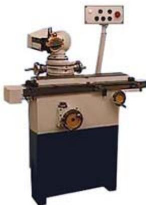
Универсально-заточный станок ВЗ-318Е предназначен для заточки и доводки основных видов режущих инструментов из инструментальной стали, твердого сплава и минералокерамики абразивными, алмазными и эльборовыми кругами.
