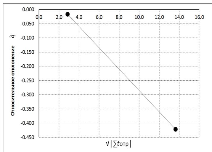
Рисунок И.1 – Зависимость относительных отклонений  $q$  от корня квадратного из модуля нарастающей суммы отрицательной температуры воздуха для ГП р. Алей – с. Локоть за осенне-зимний период 2004 года
