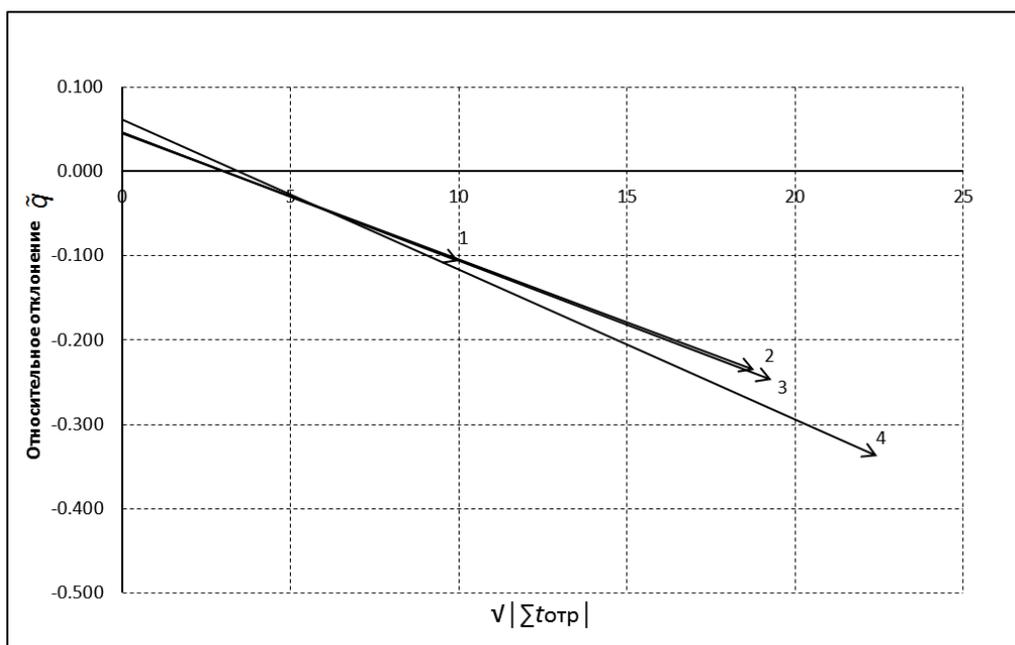
Рисунок И.2 – Зависимость относительных отклонений  $\tilde{q}_n$  от корня квадратного из модуля нарастающей суммы отрицательной температуры воздуха для ГП р. Алей – с. Локоть за осенне-зимний период 2005 года
