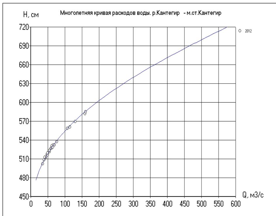
Рисунок 1 – МКР с нанесенными точками ИРВ расчетного года
