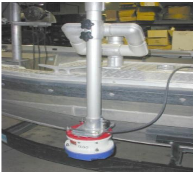
Рисунок 5 – Крепление профилографа к корпусу катера
