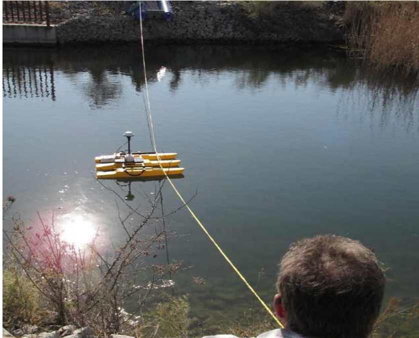
Рисунок 3 – Перемещение профилографа по створу с помощью перетяжки
