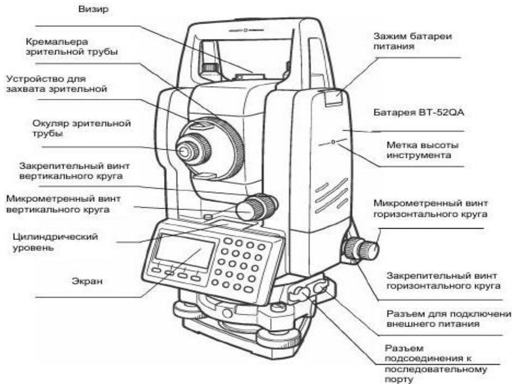
Рисунок Б.1 – Основные конструктивные элементы тахеометра
