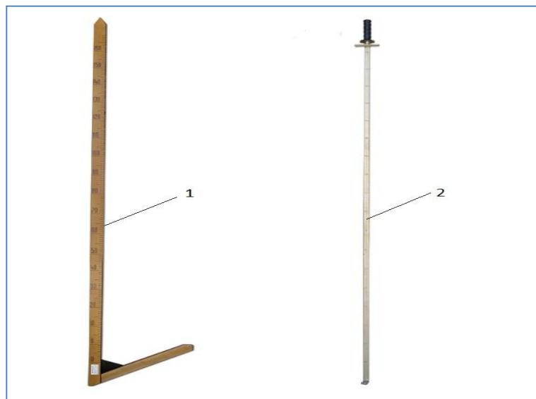
1 – ледоснегомерная рейка ГР-31; 2 – ледомерная рейка ГР-7 Рисунок 12 – Рейки для измерения толщины льда и шуги
