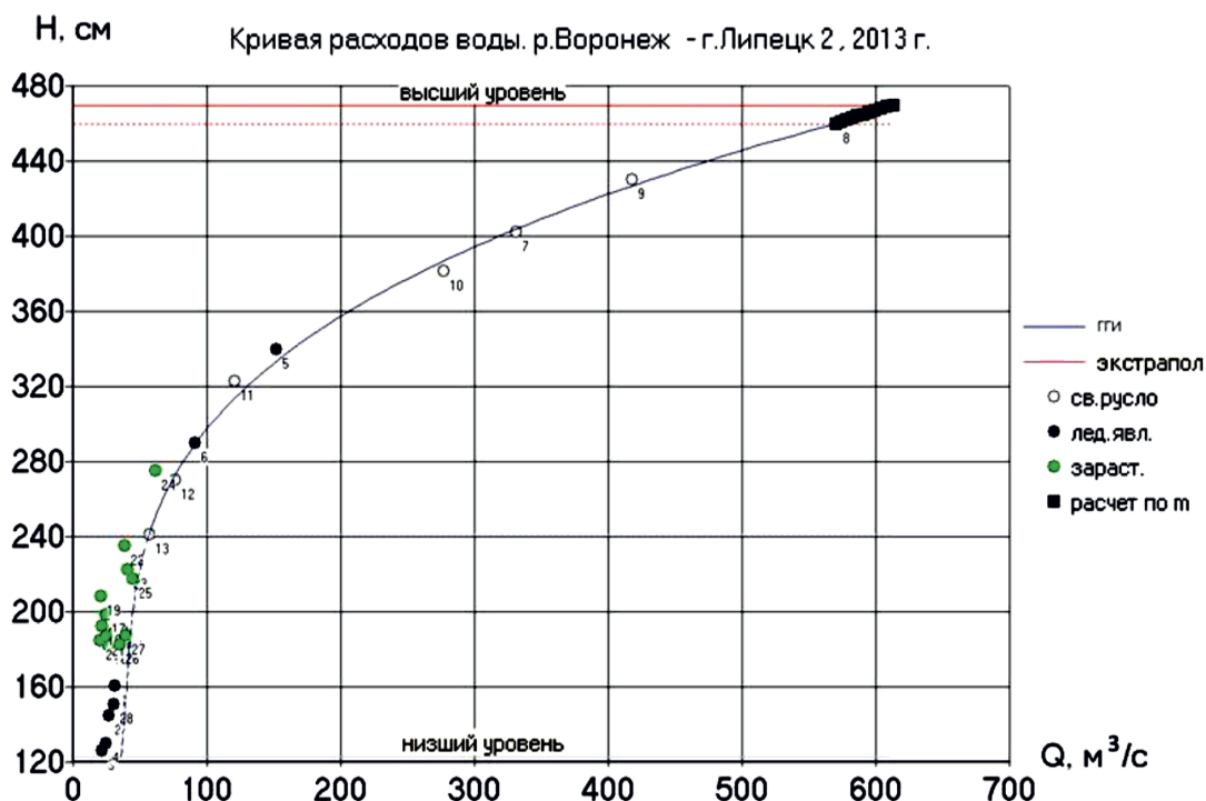
Рисунок Н.2 – Годовая зависимость расходов от уровней воды, ГП р. Воронеж – г. Липецк, 2013 год
