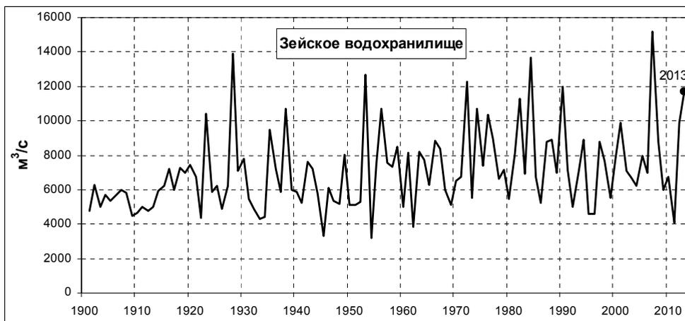
Рисунок 9 - Многолетние изменения максимального суточного притока к Зейскому водохранилищу (уточненная версия ПИВР Зейского водохранилища)
