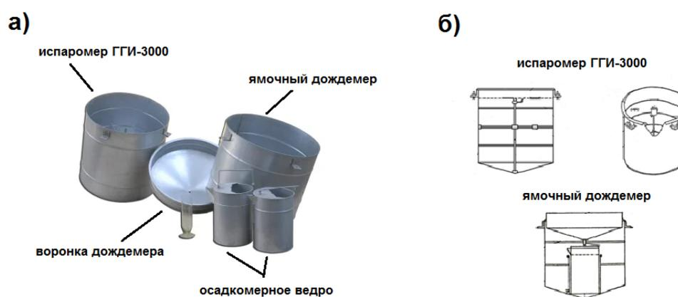
Рисунок 3.1 - Общий вид испарителя ГГИ-3000 с ямочным дождемером (а) и их схематические изображения (б)
