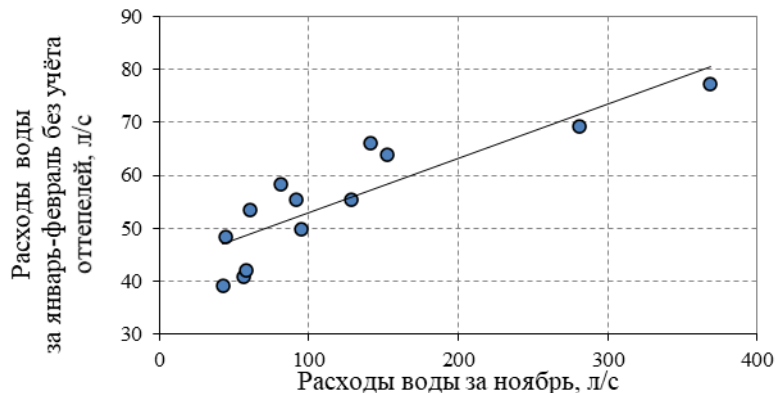
Рисунок 2.46 - Связь средних месячных расходов воды за ноябрь и за январь-февраль (осредненные значения) без учета оттепелей (р. Медвенка)
