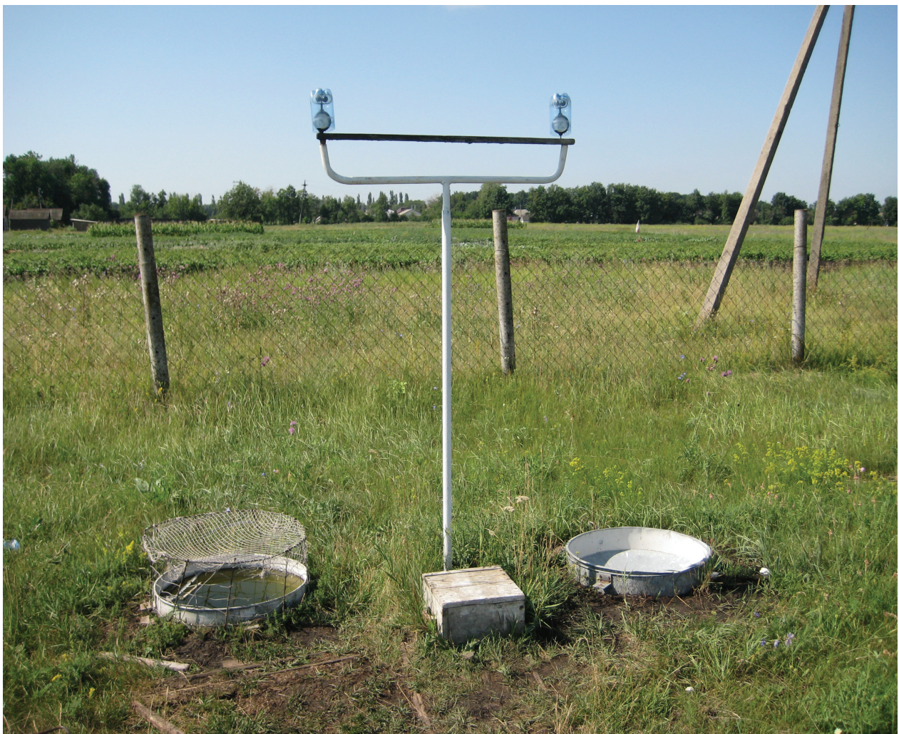
Фото 1.2. Водно-испарительная площадка на ВБС Каменная Степь
