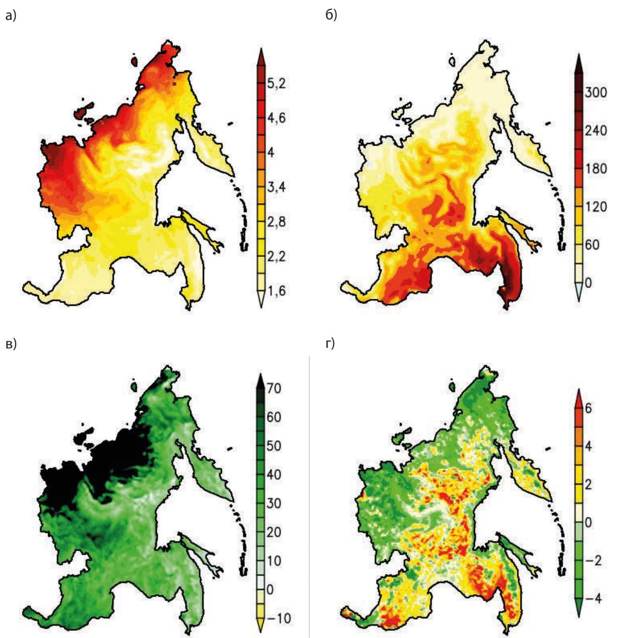
**Рис. 3.9** Изменение специализированных климатических показателей на территории ДФО в 2050-2059 гг. по отношению к 1990-1999 гг.: а) средняя температура отопительного периода ( $^{\circ}\text{C}$ ); б) дефицит холода ( $^{\circ}\text{C}\cdot\text{сум}$ ); в) суточный максимум осадков холодного сезона (%); г) максимальная продолжительность непрерывного периода с осадками меньше 5 мм/сутки для теплого сезона (дни). Сценарий RCP8.5 МГЭИК
