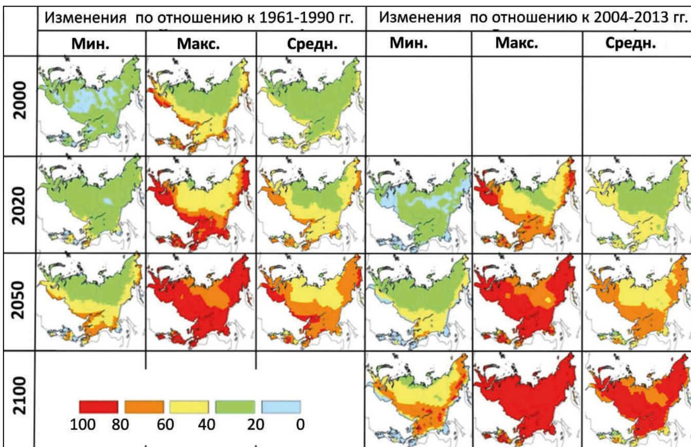
**Рис. 2.13** Относительные изменения (%) несущей способности свайных фундаментов, обусловленные увеличением температуры многолетней мерзлоты. Расчет по ансамблевому климатическому сценарному прогнозу CMIP5 для сценария RCP8.5
