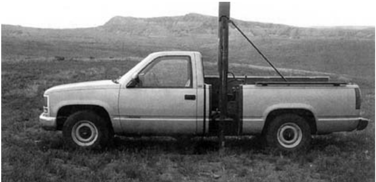
Рисунок I.4.11. Труба для взятия проб с гидравлическим приводом на базе небольшого грузовика. Труба с открытым верхом находится в рабочем положении. Гидравлические регуляторы расположены справа.
