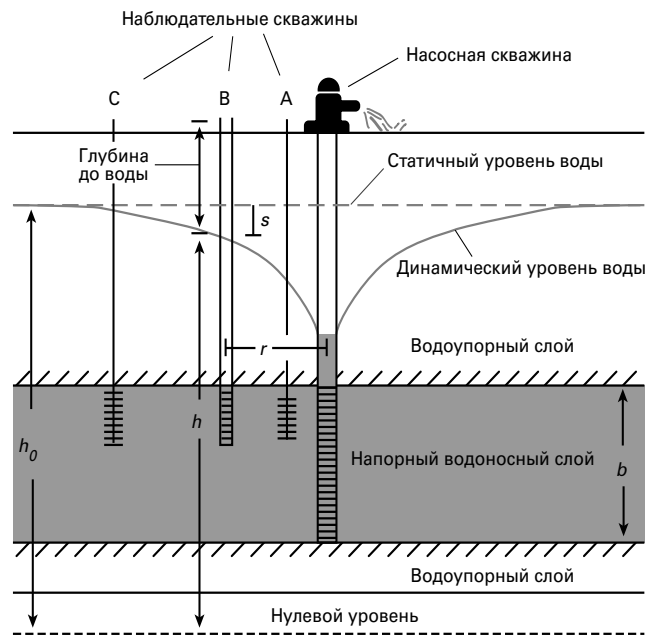
Рисунок 6.11. Схематическая диаграмма обычного испытания водоносного слоя, показывающая различные измерения (Heath, 1983)
