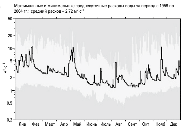
Рисунок I.10.10. Пример гидрографа, построенного по ежедневным данным о стоке
