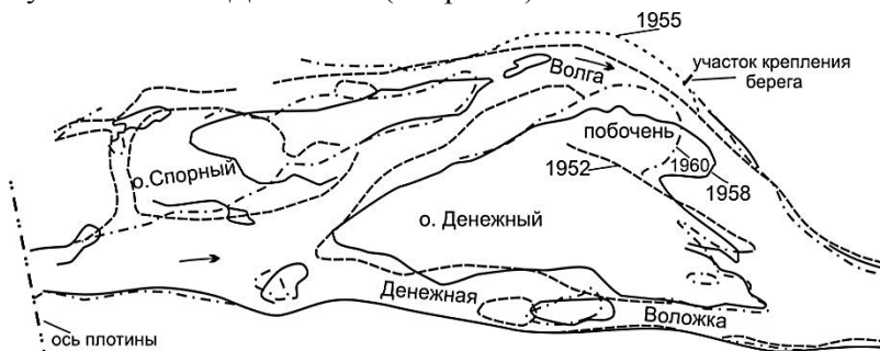
Рис. 14. Схема деформаций р. Волги на приплотинном участке за период строительства и первых лет эксплуатации ГЭС 1952-60 гг. (по Россинскому)
