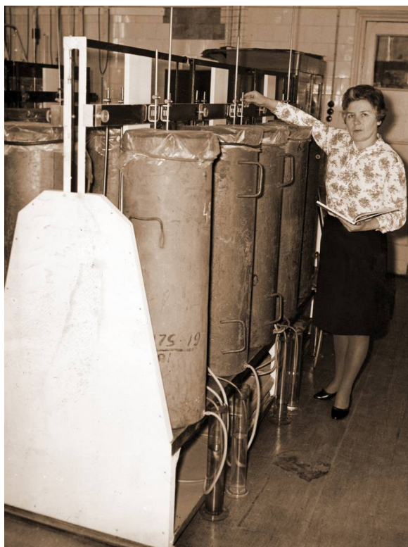
Рисунок 6.5. Установка для изучения водоотдачи торфяной залежи деятельного слоя
