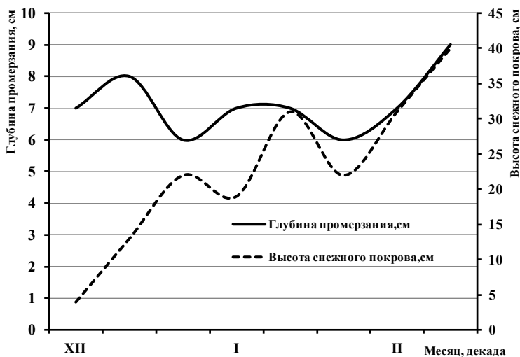
Рисунок 11.3. Хронологический график изменения промерзания торфяной залежи и высоты снежного покрова зимой 1991–92 годов (сфагново-кустарничково-сосновый микроландшафт)
