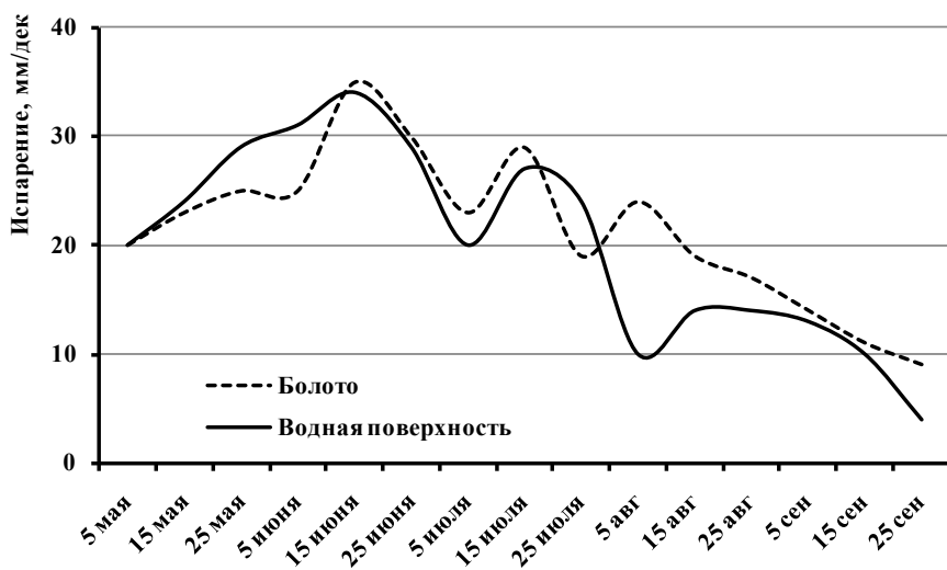
Рисунок 12.19. Совмещенный график хода декадных величин испарения с болота и с водной поверхности за вегетационный период. Влажное лето, 1974 год, сумма осадков – 407 мм.
